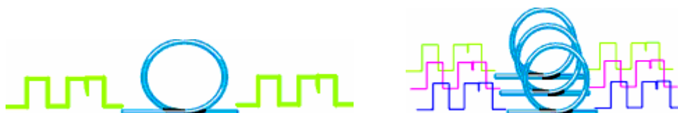
Σχήμα 2-1. Δυαδική σηματοδότηση με ένα και περισσότερα παράλληλα καλώδια.
